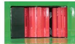
Широкое входное окно с вертикальными вальцами, и защитной рамкой - препятствуют блокировке при работе
